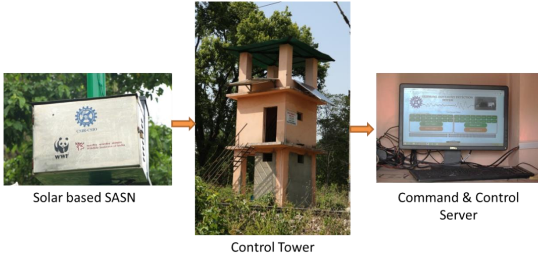
कंसराव, आरटीआर पर नियंत्रण सर्वर और उपयोगकर्ता इंटरफेस के साथ फील्ड नोड्स (SASN) का लेआउट
