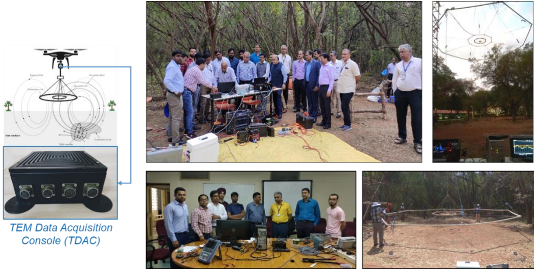
चित्र 3- विकसित टीडीएसी मॉड्यूलय CSIR-NGRI परीक्षण स्थल पर एकीकृत प्रणाली का फील्ड परीक्षण
